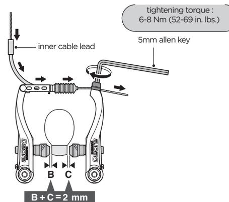
3. Ajuste o balanço com os parafusos de afinação da tensão das molas.
