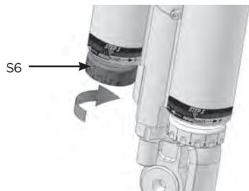
Usando os botões de ajuste (S6 e S7) na parte inferior do amortecedor pode ajustar o Rebound passo a passo
