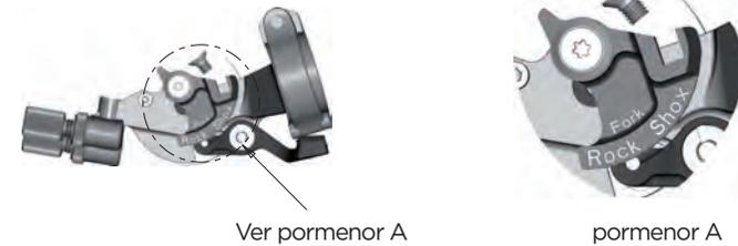
Para proceder há montagem do cabo deverá colocar o manípulo na posição de Curso Total, deslizar o cabo como demonstrado na Imagem abaixo, passá-lo pela espiral de cabo pré-dimensionada e fixá-lo na unidade de montagem no topo direito da coroa da suspensão.
