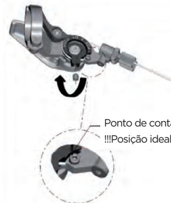
Ponto de contacto (adaptador/parafuso)
