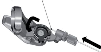
Fixe o cabo através do parafuso Allen de 2mm com um torque máximo de 0.9Nm tal como mostrado na Imagem seguinte
