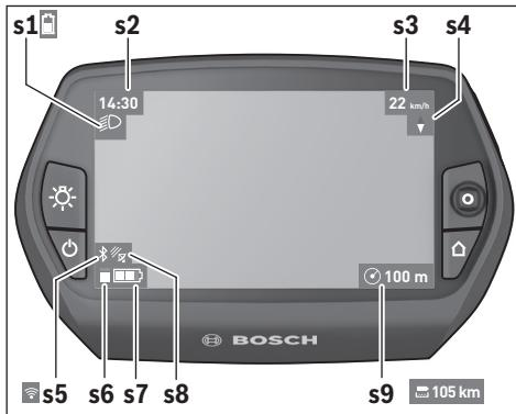
**s1** Ένδειξη φωτισμού ποδηλάτου/Ένδειξη κατάστασης φόρτισης μπαταρίας Nyon
