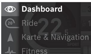
Mit dem Joystick **1** können Sie durch Drücken nach links den aktiven Betriebsmodus mit dem Hauptmenü überblenden und in das Hauptmenü wechseln (siehe Bild oben).
