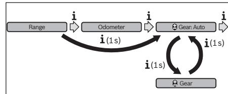
Ved å trykke på knappen «**i**» i mer enn ett sekund kan du veksle mellom den automatiske modusen «**Gear: Auto**» (**Automatgir**) og den manuelle modusen «**Gear**» (**gir**). Hvis du kjører i 1. gir i manuell modus, kan du også trykke på knappen «**-**» **11** for å skifte til modusen «**Gear: Auto**» (**Automatgir**). Ved å trykke på knappen «**-**» **11** på nytt kan du skifte til manuell modus igjen. Det er også mulig å skifte til manuell modus ved å trykke på knappen «**++**» **12**.
