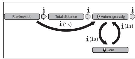
Ved at trykke på tasten „i“ i mere end 1 s kan du skifte frem og tilbage mellem den automatisk modus „**Autom. gearvalg**“ og den manuelle modus „**Gear**“.
