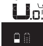
Si en una eBike provista de dos baterías se cargan ambas en la bicicleta, en la pantalla aparecerá el progreso de carga de las dos baterías (en la ilustración se está cargando la batería izquierda). Puede saber cuál de las dos se está cargando en cada momento observando el indicador intermitente de las baterías.
