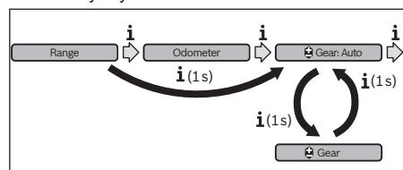
Painamalla painiketta "i" yli 1 s ajan voit vaihdella automaattisen tilan "**Gear: Auto**" (**automaattinen vaihteenvaihto**) ja manuaalisen tilan "**Gear**" (**vaihde**) välillä.
