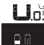
Se numa eBike com duas baterias colocadas forem carregadas ambas as baterias na bicicleta, então no mostrador é exibido o progresso de carregamento de ambas as baterias (na imagem está a ser carregada de momento a bateria esquerda). Qual das baterias está a ser carregada é reconhecível na indicação a piscar na bateria.
