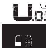
Se in una eBike con due batterie inserite verranno caricate entrambe le batterie, sul display verrà visualizzato l'avanzamento della carica per entrambe le batterie (nella figura, la batteria in fase di carica è quella sinistra). L'indicazione lampeggiante sulla batteria indicherà quale delle due batterie si trovi al momento in fase di carica.
