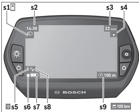
**s1** Indicador de la iluminación de la bicicleta/Indicador del estado de carga de la batería del Nyon
