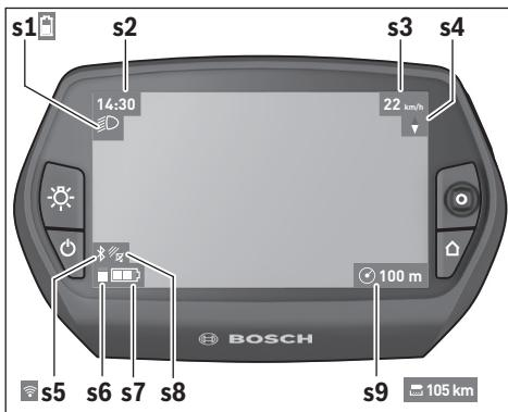
**s1** Indicação da iluminação da bicicleta/indicador do nível de carga da bateria Nyon
