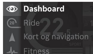
Med joysticken **1** kan du ved at trykke mod venstre skjule den aktive driftstilstand bag hovedmenuen og skifte til hovedmenuen (se billede ovenfor).
