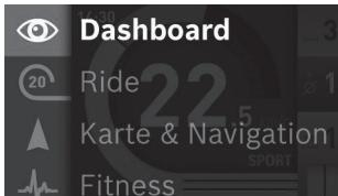
Mit dem Joystick **1** können Sie durch Drücken nach links den aktiven Betriebsmodus mit dem Hauptmenü überblenden und in das Hauptmenü wechseln (siehe Bild oben).
