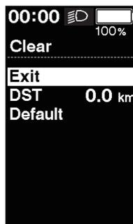
2. Para reiniciar o contador parcial, selecione [OK] utilizando X ou Y e pressione A para confirmar. Após a reinicialização, a tela retornará automaticamente à tela da lista de menus.
