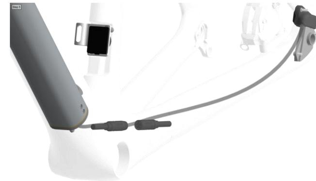
Conecte o sensor de velocidade dentro do quadro.
